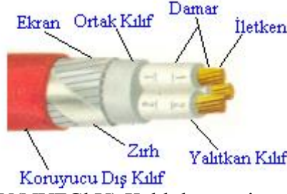
Şekil 2.1 YVŞV(NYFGbY) Kablounun iç yapısı (siemens)
